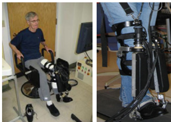
Figura 1 - Anklebot, um robô projetado para auxiliar a terapia e avaliar a função do tornozelo de pacientes com alteração de marcha.
