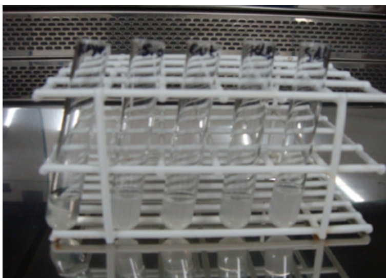
Figura 1. Suspensão bacteriana em tubo de ensaio com turvação a 0,5 na escala de Mac Farland.
