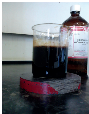
Figura 4(b): Separa o magn tica das part culas atrav s de um im 
