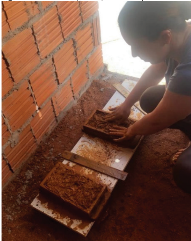
Figura 9 - Processo de regularização da face superior
