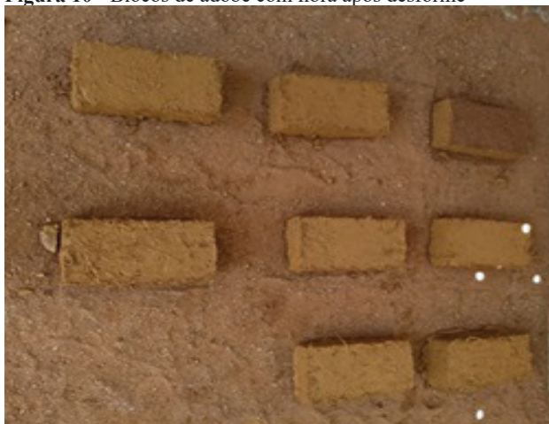
Figura 10 - Blocos de adobe com fibra após desforme
