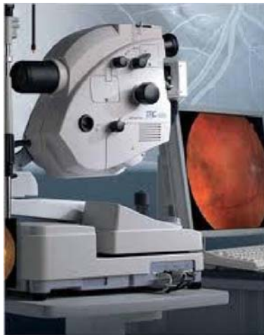
Figura 4.2. Foto de um retinógrafo comercial digital TRC-50DX.
