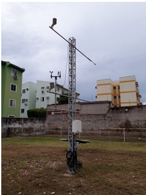
Figura 1 - Estação Meteorológica Automática do Campus de Universidade de Cuiabá
