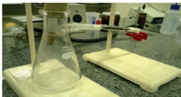
Figura 3: Sistema construído para a captura de SO 2
