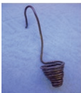
Figura 2: Porta amostra utilizado para simular o processo de combustão do enxofre
