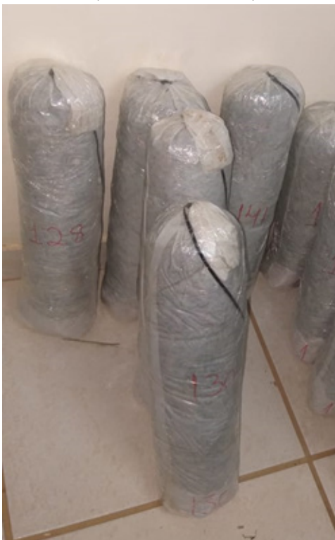
Figura 1 - Minissilos experimentais confeccionados com lâminas de polietileno com 10,0 cm de diâmetro e 40,0 cm de altura
